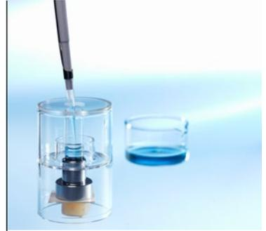
校准移液器时均使用原厂吸头，校准用水符合GB 6682的校准用水要求，确保每次校准精确、可靠。
