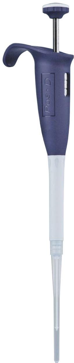
瑞宁Pos-D外置活塞式移液器极为适用于对具有高密度、粘度或蒸汽压力的液体进行移液。
