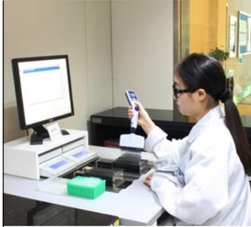
快速、灵活、精确的MCP多道移液器校准工作站，可实现快速不间断校准，大大缩短多道移液器校准所需花费的时间，自动化的数据传输记录保存，确保符合CFR Part 11电子签名和电子记录要求。
