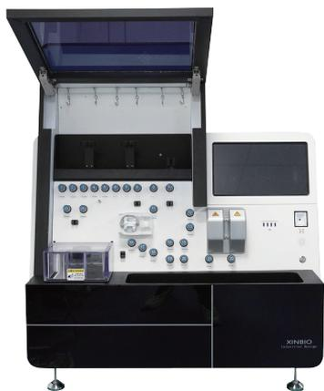
图1.1 全自动细胞制备一体机主机正面
