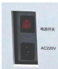
图2.1 主电源开关
