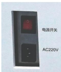
图1.4 电源开关与电源接口
