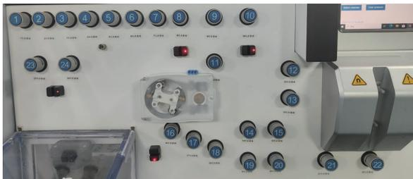
图 1.12 夹管阀和液体传感器
